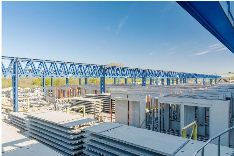
**Bildbeschreibung:** Betonfertigteile und Außenwandelemente sind für den Transport zur Baustelle bereit.
